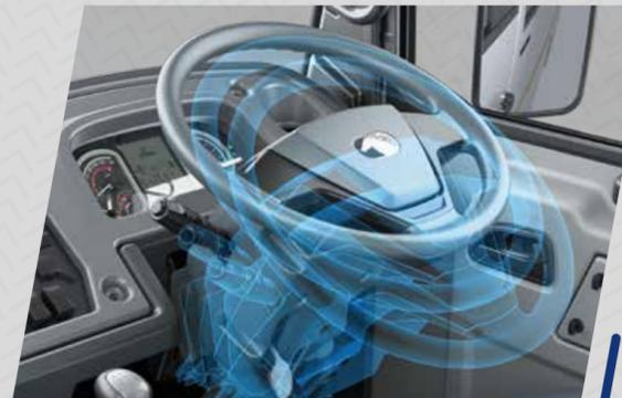
Direction assistée inclinable et télescopique
