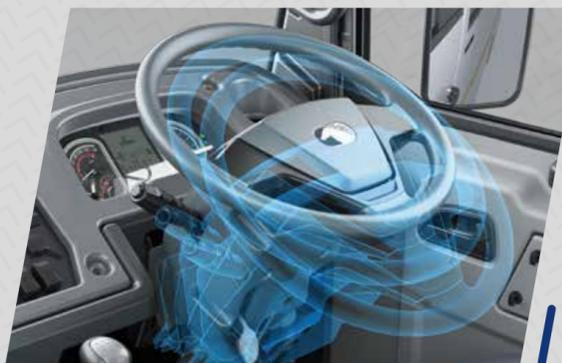
Direction assistée inclinable et télescopique
